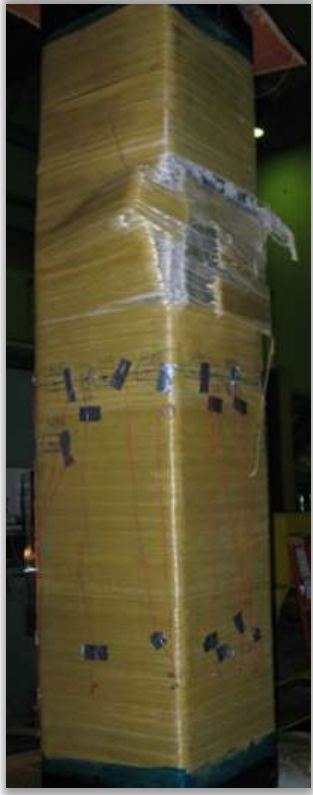
UM – GFRP Wrapped Columns
